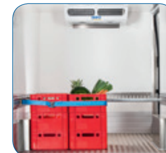
Schlag- und kratzfeste Wände aus glasfaserverstärktem Kunststoff, Radkästen aus Edelstahl
