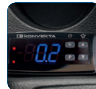
Fernbedienung mit Temperaturanzeige im Fahrerhaus
