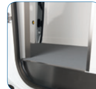
Empfindliche Stellen im Schiebetürenbereich werden durch Edelstahlprofile geschützt
