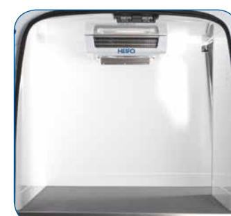
Schlag- und kratzfeste Wände aus glasfaserverstärktem Kunststoff, ohne Radkästen im Laderaum
